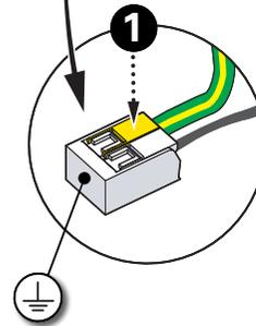
1 Insérer le fil **non dénudé** jusqu'au fond du bornier.
